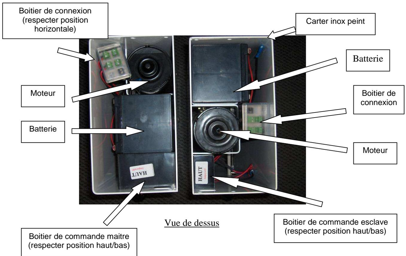
**Note :** Le bloc moteur maître se différencie du bloc moteur esclave uniquement par la dimension de son boîtier de commande.
